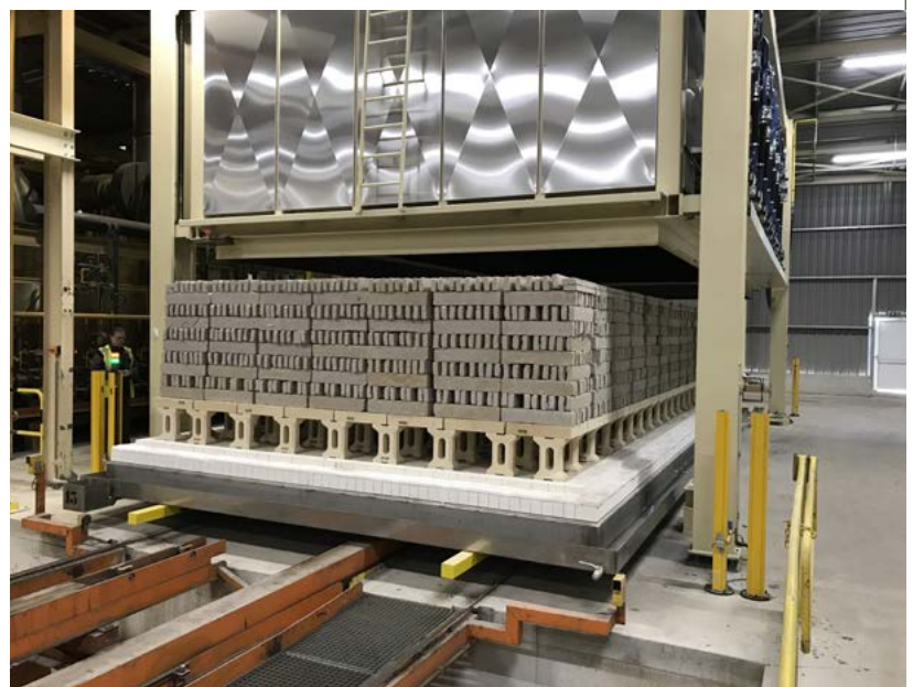
Dans un four à réduction, totalement rempli de gaz, les briques ou tuiles prennent une couleur différente.
